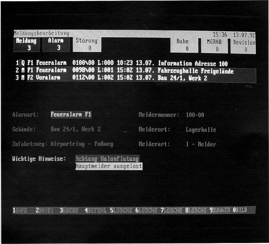
Bild 5 Monitordarstellung einer Meldung mit Kurzinformation und Klartext
